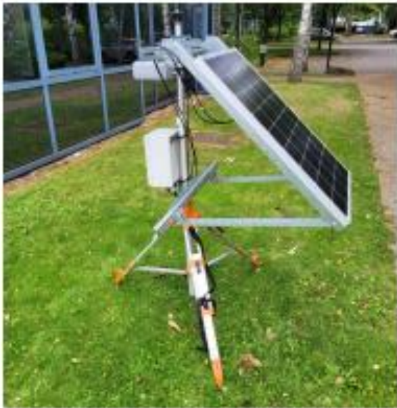
Installation panneau solaire 120W sur trépied
