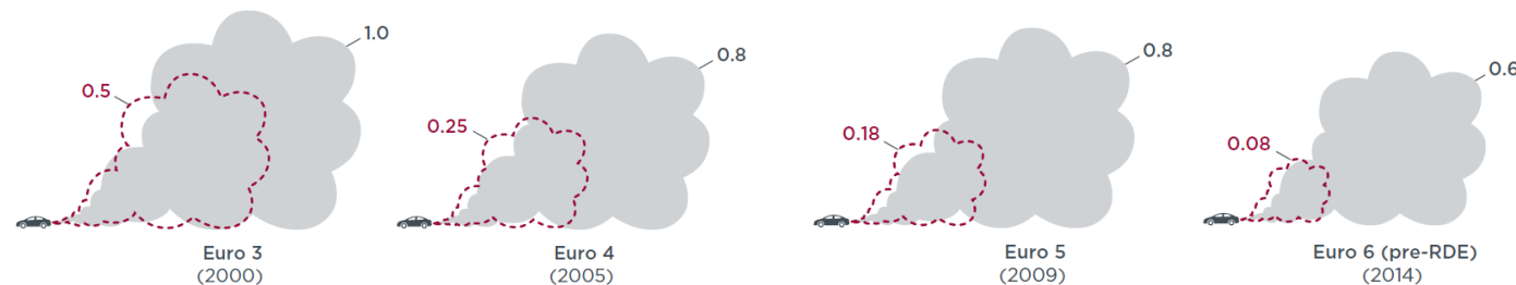
Emissions moyennes de NOx véhicules diesel en g/km, norme vs. conditions réelles – Source : ICCT
