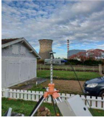
Figure 2: installation de suivi des poussières fines au dynamitage— hors site
