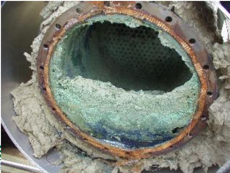
Dégâts dus à l'H 2 S (source Pro2)
