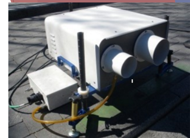
Module source/détecteur Spectroscopie IR (CO) et UV (HC, NO) Opacimétrie (PM)
